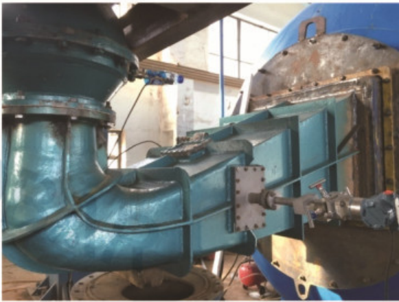
为黑龙江三江联通项目 在肘形进水水道非标准断面进水水道实验
